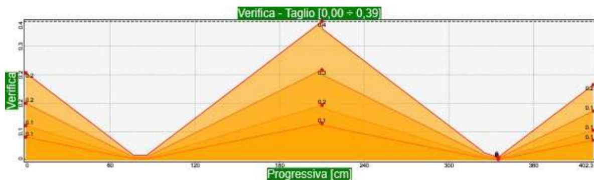
Situazione di progetto 1 • SLU Fondamentale, Permanente ÷ Taglio
