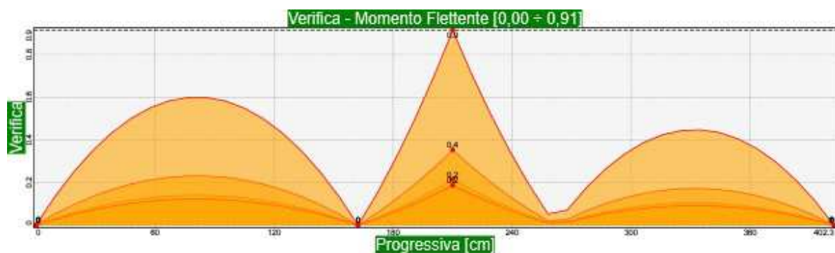
Situazione di progetto 1 • SLU Fondamentale, Permanente ÷ Flessione
