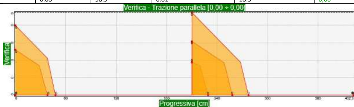
Situazione di progetto 4 • SLU Eccezionale, Incendio R60, Istantaneo ÷ Tensione parallela
